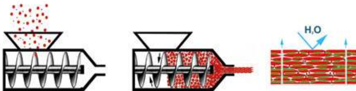
Proceso y estructura materiales extrudidos Gres de Aragón
