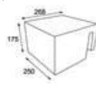
Pieza maciza esquina de nicho/anclaje corchera Niche corner piece/lane rope fixing piece
